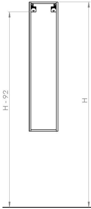
Toutes les cotes en mm. Les cotes sont données en bas de la patte murale. All dimensions in mm. The dimensions are given to the bottom of the wall plate.
