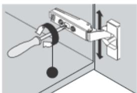
La vis située au milieu permet le réglage sur la hauteur.
