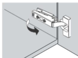
Attraper la charnière par le "clapet" arrière et tirer vers l'avant
