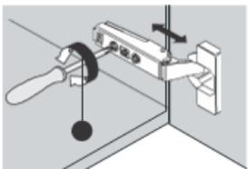
La vis de réglage situé sur l'arrière de la charnière permet le réglage sur la profondeur.
