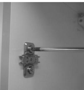
Percer un  $\varnothing 5\text{mm}$  de profondeur 12mm à partir des pré-perçages puis visser les embases du côté gauche
