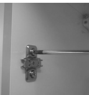
Percer un \varnothing 5 mm de profondeur 12mm à partir des pré-perçages puis visser les embases du côté gauche
