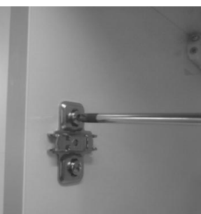
Percer un Ø5mm de profondeur 12mm à partir des pré-perçages puis visser les embases du côté gauche
