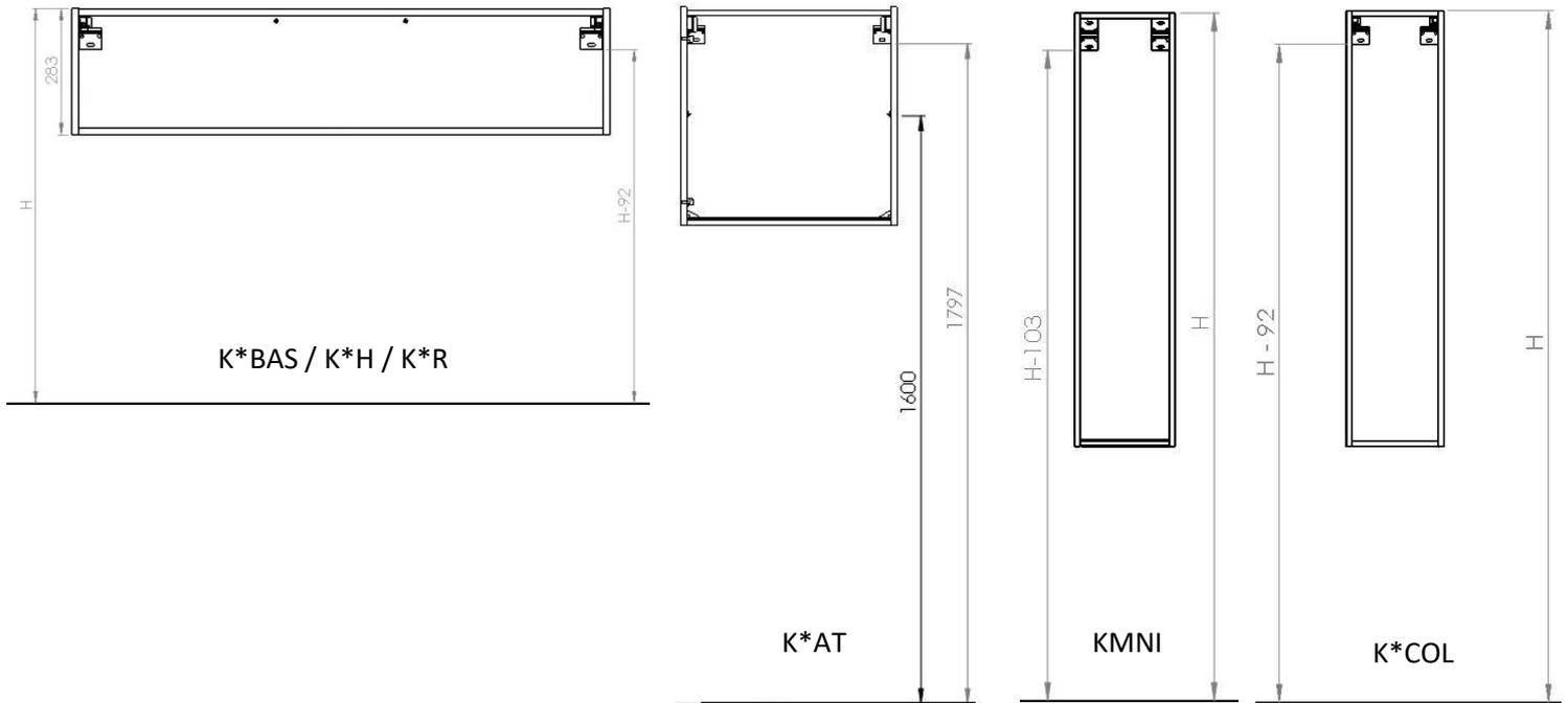
Toutes les cotes en mm. Les cotes sont données en bas de la patte murale. All dimensions in mm. The dimensions are given to the bottom of the wall plate.
