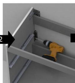
2 Fixer l'équerre sur le meuble Fixing the brackets on the unit
