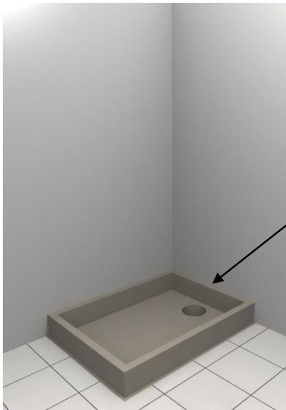
Il est préconisé dans tous les cas de mettre en place une ceinture périphérique (béton cellulaire ou bois) tout autour de la réserve pour faire reposer le receveur (épaisseur maximale 5 cm)
