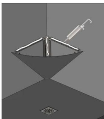
5. Positionner la coque, Visser les pattes de fixation. Siliconer le dessus des 3 équerres.
