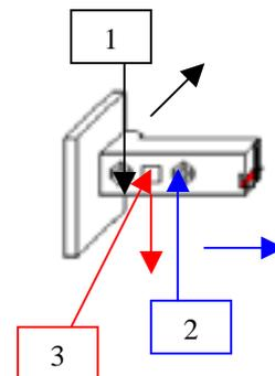
Pour les tiroirs, enlever les caches plastiques Ambiance Bain, et régler grâce aux vis suivant le schéma L suivant.
